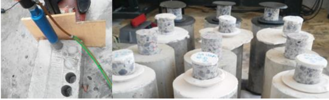
Şekil 4. Kütte betonundan karot alınması ve başlıklanması
