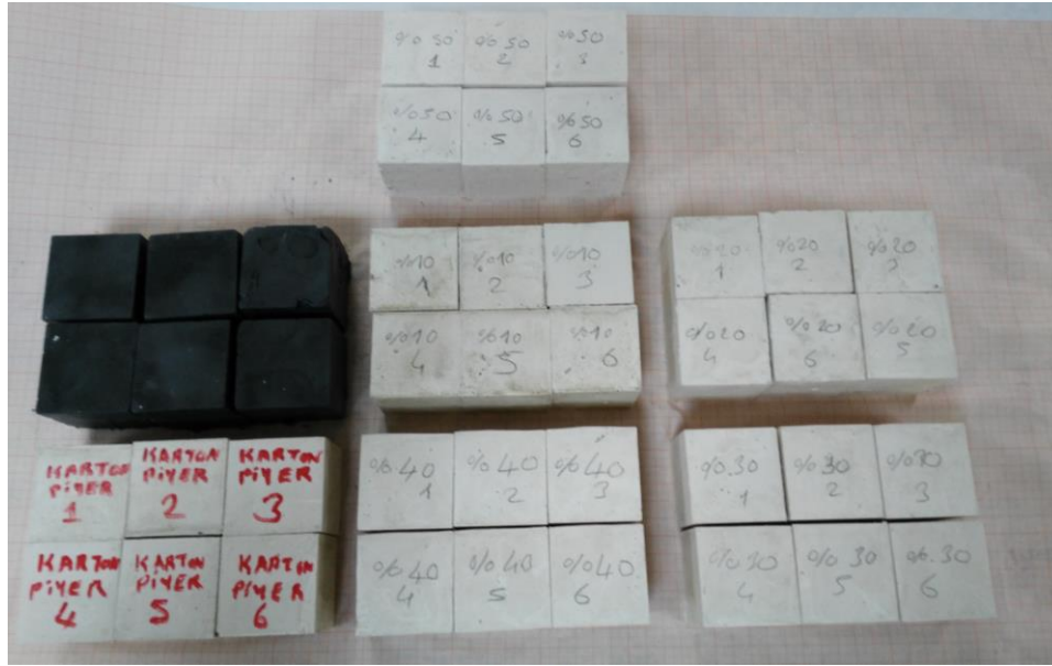
Şekil 2. Basınç testi için 5x5x5 cm'lik küp numuneler
